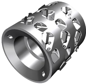
Fräser, Diamant Ø 70 x 64 x 30 mm, Z2+2, Linkslauf Air Stream System (HOLZ-HER / LEUCO Patent) Für Fügefrässaggregat 1801 / 1802
