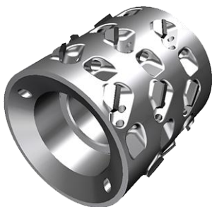
Fräser, Diamant Ø 70 x 64 x 30 mm, Z2+2, Rechtslauf Air Stream System (HOLZ-HER / LEUCO Patent) Für Fügefrässaggregat 1801 / 1802
